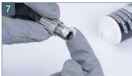
Nasmarować gwint śruby regulatora przepływu materiału
