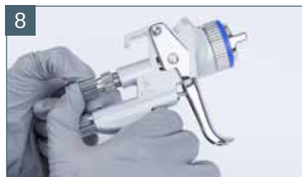
Zamontować śrubę regulatora przepływu materiału
