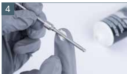
Nasmarować iglicę w obrębie uszczelki
