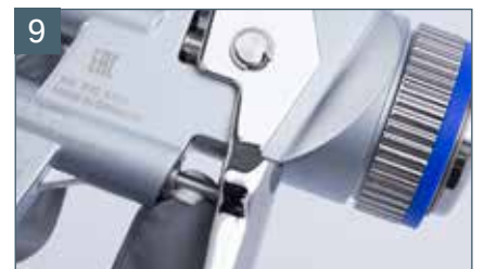
Nasmarować widoczną część tłoczka powietrza
