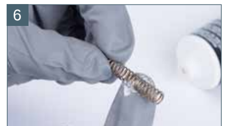
Nasmarować sprężynkę i nałożyć na iglicę
