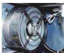
Inteligentny system chłodzenia -Kompresory z serii New silver są wyposażone w niezależne chłodzenie kontrolowane przez sterownik FIAC EASY CONTROL. Utrzymanie stałej temperatury powietrza oraz oleju gwarantuje dużą żywotność podzespołów nawet w ciężkich warunkach.
